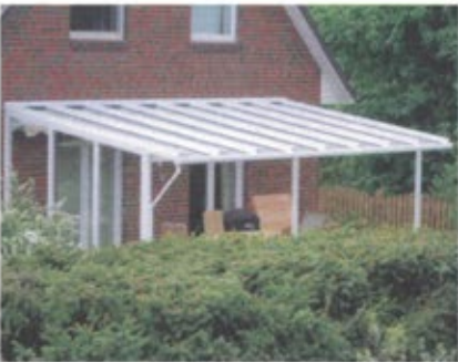
Pultdach mit vorgehängter Rinne
